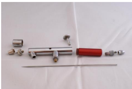
Aéro Rewell démonté pour nettoyage
